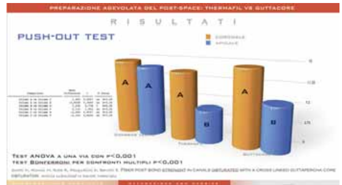
Figura 3 Diapositiva della media, deviazioni standard ed analisi statistica dei valori di forza di adesione (espressi in MPa/mm 2 ) ottenuti nello studio sui perni cementati in canali otturati con 3 diverse tecniche (Condensazione verticale, Thermafil e Guttacore).
