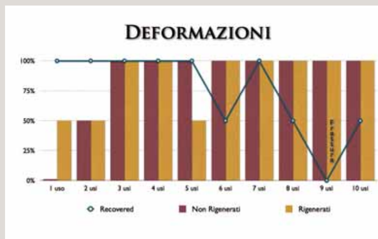
Fig. 5 Percentuale di strumenti deformati nel gruppo A (non self-restored) e nel gruppo B (self-restored) dopo l'uso e possibilità di recupero grazie alla procedura di rigenerazione. La possibilità di recupero è stata considerata 100% quando su tutti gli strumenti della serie non ci sono state differenze statisticamente significative tra lo strumento prima dell'utilizzo e dopo l'utilizzo e la rigenerazione.
