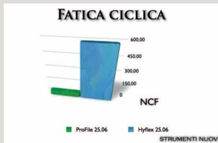
Fig. 7 Grafico della fatica ciclica di strumenti nuovi della stessa taglia 25.06 costruiti con NiTi tradizionale e CM-wire (Hyflex).
