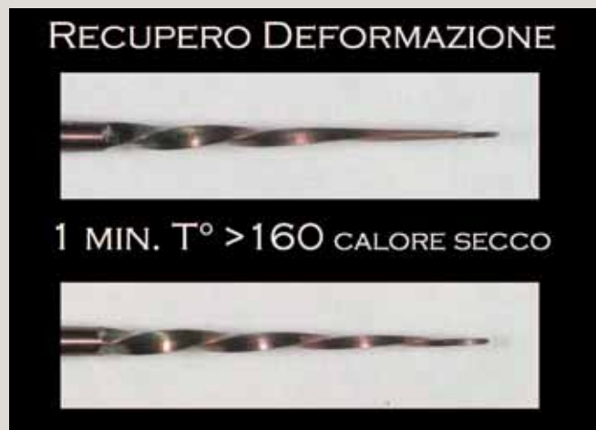
Fig. 2 Strumento Hyflex 25.04 dopo l'utilizzo che ne ha determinato una deformazione (in alto). Lo stesso strumento dopo lo shock termico a 160 °C per 60 sec. (in basso) appare aver recuperato la sua morfologia iniziale grazie alla proprietà di memoria di forma.
