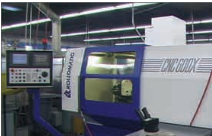
FIG. 1 Tornio computerizzato per la costruzione di strumenti endodontici in Ni-Ti.
