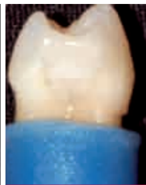
FIG. 2 Campione inglobato in resina pronto per il test di fatica statica.
