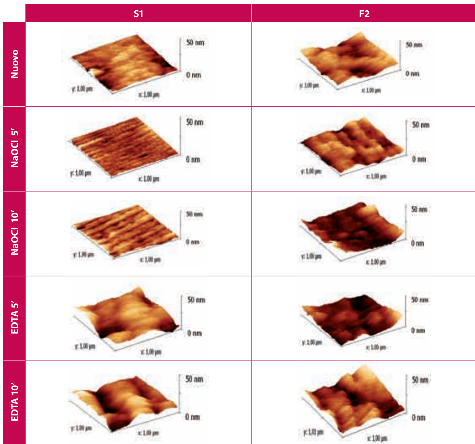
FIG. 2 Immagini tridimensionali di superfici all'AFM dei files ProTaper S1 e F2 nuovi e immersi in NaOCl ed EDTA per 5 o 10 minuti.
