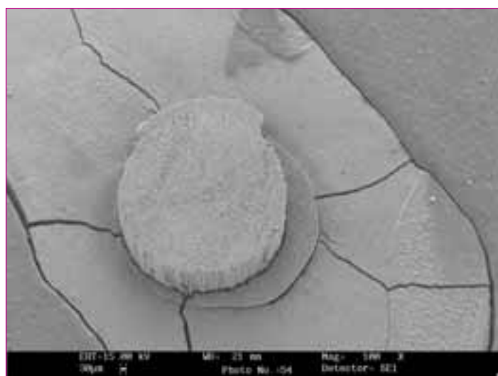
Fig. 6 - Microfotografia al SEM (100x) appartenente al segmento intermedio di un campione del gruppo "Perno" ed andato incontro ad un cedimento misto di tipo 2.
