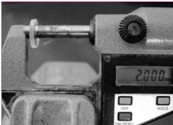
Fig. 3 - Controllo dello spessore delle sezioni, eseguito per mezzo di un calibro digitale.
