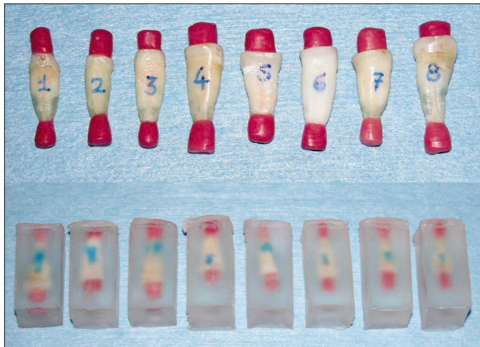
Fig. 1 - Immagine dei campioni approntati per il test di infiltrazione a pressione.
