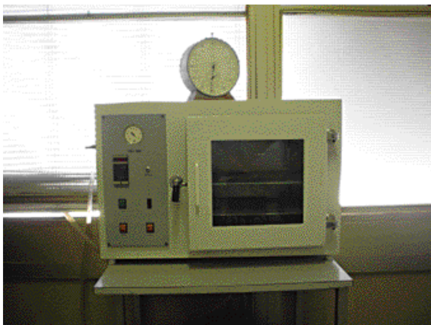
Fig. 2 - Camera stagna collegata alla pompa da vuoto utilizzata nello studio per applicare pressioni inferiori alla pressione atmosferica.
