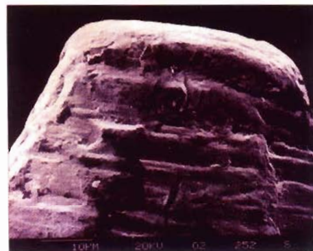
Fig. 14 - Le modifiche della micromorfologia di superficie dei ProFile non impiantati appaiono più evidenti a carico della porzione apicale e preapicale (1500 X).
