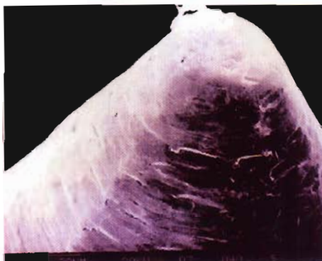
Fig. 11 - La punta degli strumenti impiantati dopo il primo minuto di lavoro alle medesime condizioni sperimentali non manifesta particolari fenomeni di usura ed appare integra, arrotondata e ben levigata (1500 X).
