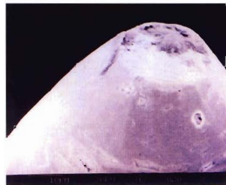
Fig. 17 - Dopo 4 minuti di lavoro i ProFile impiantati presentano una forma ed un profilo pressoché immutato a livello della loro porzione apicale (1500 X).
