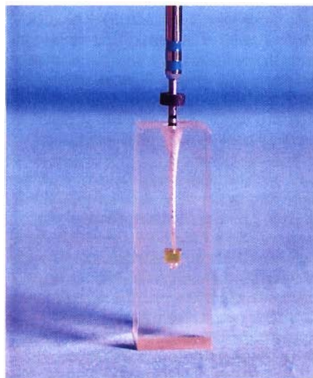
Fig. 7 - Uno degli Endo Training-Bloc utilizzati per testare le capacità alesanti degli strumenti impiantati e non.
