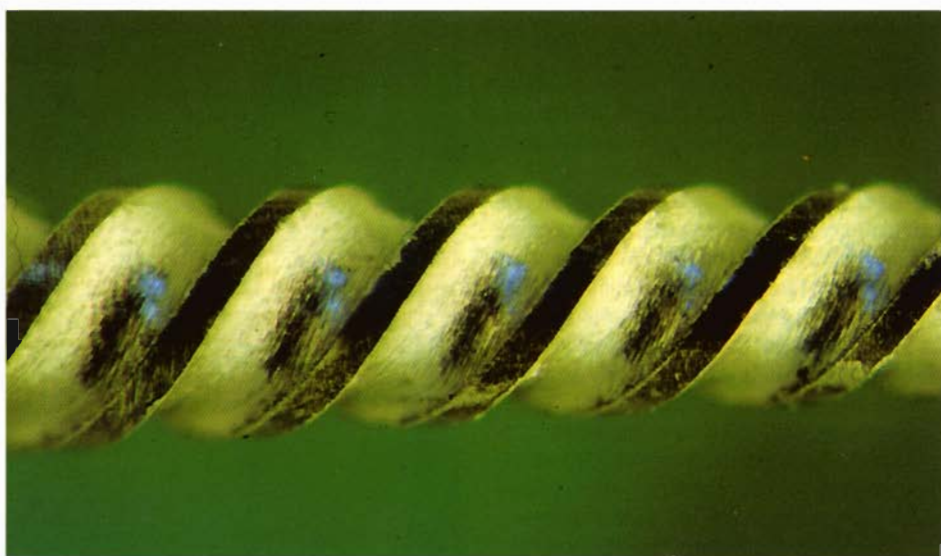
Fig. 2 - Le superfici di scorrimento di un ProFile .06 : evidenza allo stereomicroscopio.
