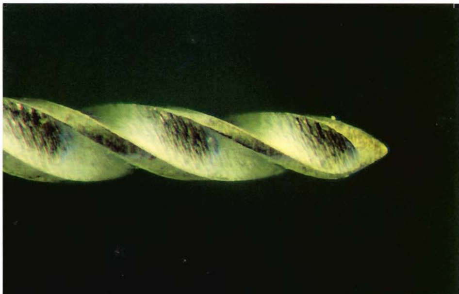
Fig. 3 - L'angolo di transizione poco aggressivo della punta dello strumento.
