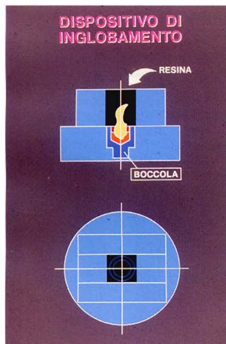
Fig. 5 - Schema del sistema di rimontaggio di precisione dei campioni (foto del dr. Elio Berutti).
