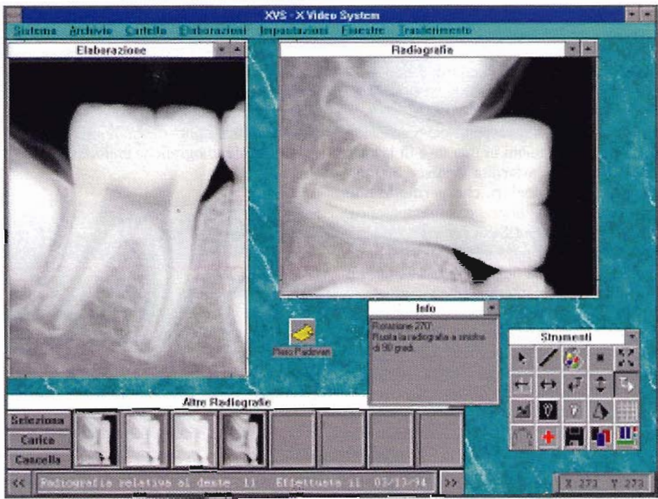
Fig. 12 - Schermo del Visualix-Castellini in una fase di lavoro, in ambiente Windows 3.1. Sono visibili le finestre di acquisizione (rx grande in alto a destra) e di elaborazione (rx grande a sinistra), la finestra con gli "Strumenti" disponibili, le "Info" con gli aiuti e le "Altre radiografie" rappresentate in formato compresso. Fig. 12 - A Visualix-Castellini screen view of one phase of treatment, using Windows 3.1. You can see the basic window (large rx on right) and the "working" window (large rx on left), the window showing available "instruments", information windows with help keys, and "other x-rays" shown in reduced size.
