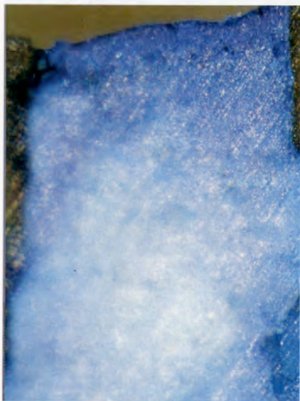
Fig. 7 - Ingrandimento a 40x della Fig. 6. Il colorante è penetrato anche all'interno del materiale da otturazione.
