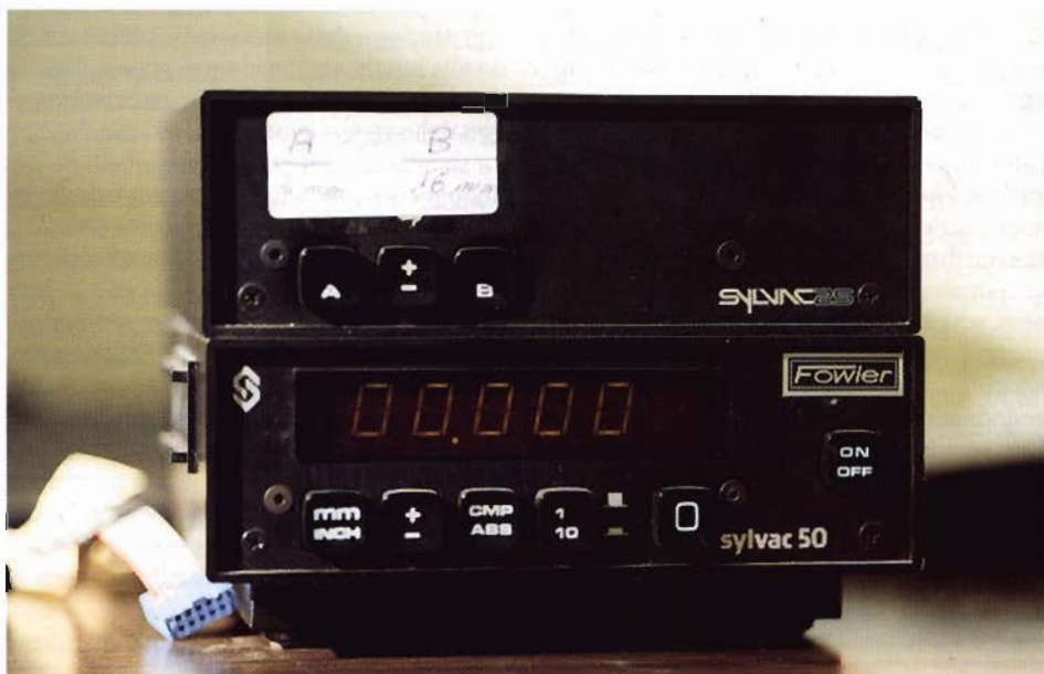
Fig. 2 - Particolare dell'apparecchiatura elettronica per la lettura digitalizzata delle misure. Si apprezza l'elevato grado di precisione ottenibile.
