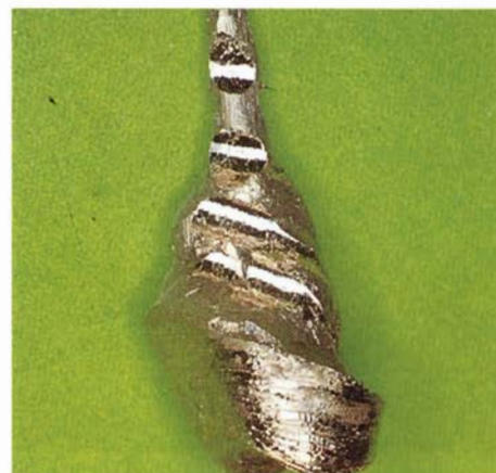
Fig. 7 - Il perno dopo l'aumento di ritenzione con tacche trasversali.
