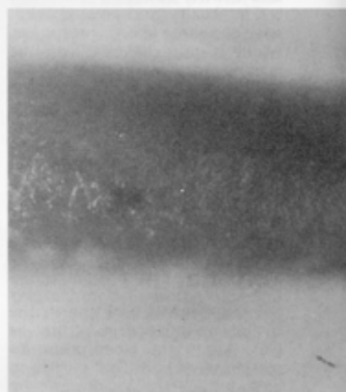
Fig. 2: Foro scavato nella dentina con la radiazione di un laser a vapori di rame (spettro visibile: 510 nm), trasmessa attraverso una fibra ottica del diametro di 600 µm. Sono evidenti i danni termici.
