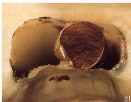
Fig. 19 - Frattura parziale localizzata a stella.
