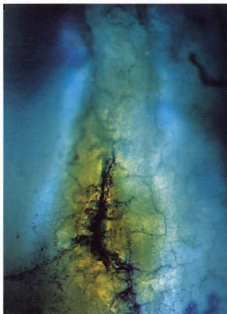
Fig. 19 - Frattura parziale localizzata a stella.
